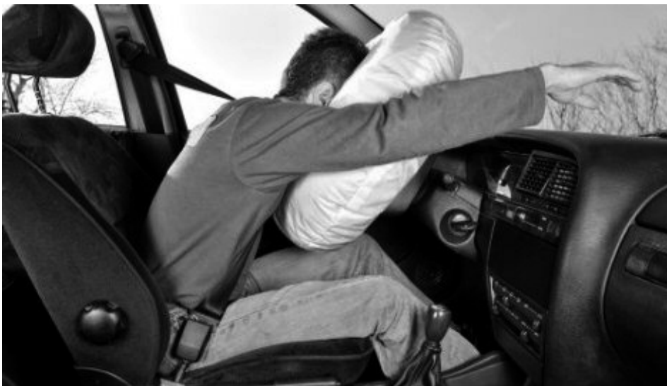
Слика 4: Положај возача при судару уз активирање сигурносног појаса и ваздушног јастука
