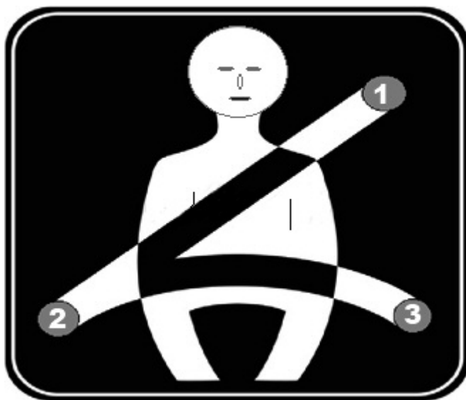
Слика 2: Три тачке ослонца (фиксирања) сигурносних појасева
